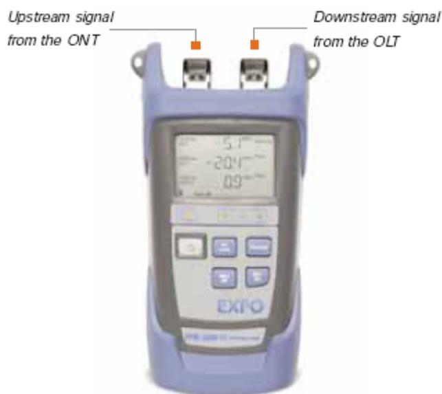
从可以看出光功率计 PPM-350B 与一般的光功率计不同的是它有一个下行输入光接口和一个上行输入光接口，且能同时显示 1310nm、1490nm 和 1550nm 3 种波长的光功率。
