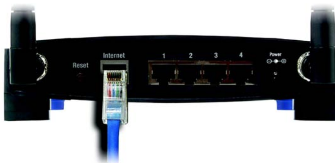
Afbeelding 4-5: Een andere router aansluiten
