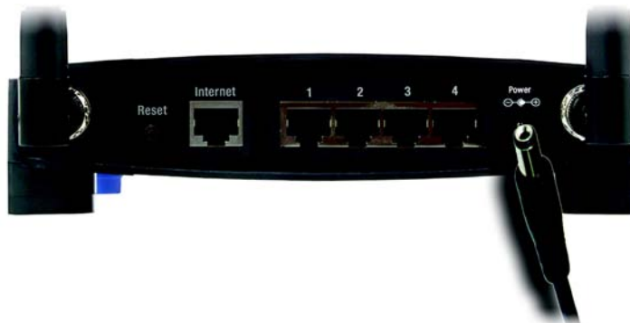
Figure 4-3 : Connexion de l'alimentation
