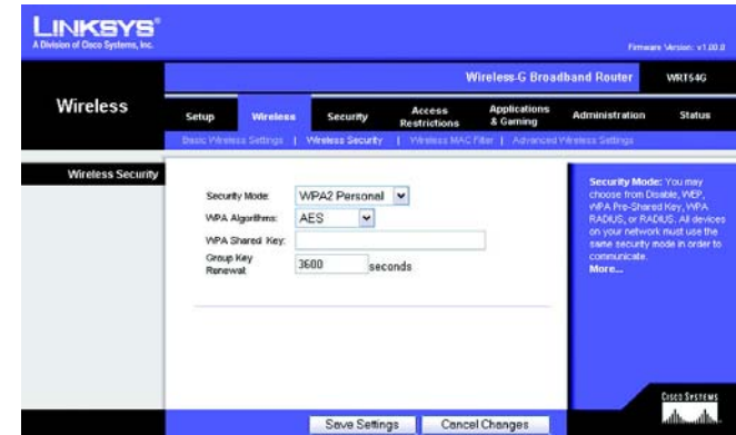
Figura 6-19: Separador Wireless (Sem fios) - Wireless Security (WPA2 Personal) (Segurança sem fios (WPA2 Personal))
