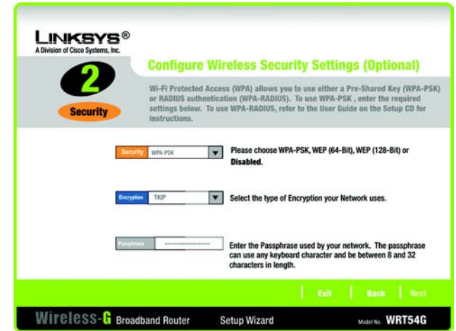
Figure 5-29 : Ecran Wireless Security - WPA-PSK (Sécurité sans fil - WPA-PSK) de l'Assistant de configuration
