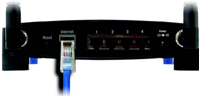
Figure 4-5 : Connexion d'un autre routeur
