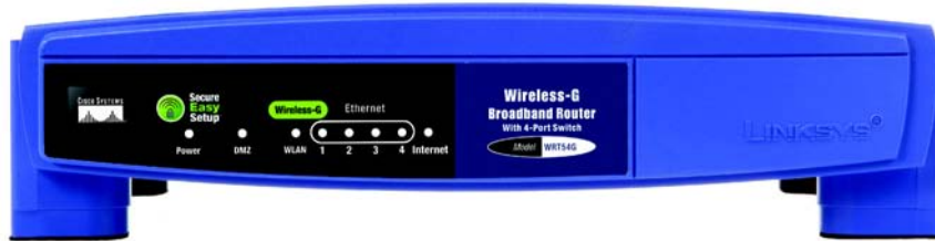
Abbildung 3-2: Vorderseite des Routers
