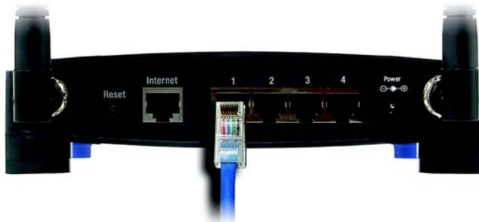
Figure 4-2 : Connexion de vos périphériques réseau
