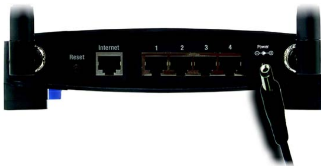
Afbeelding 4-7: De voeding aansluiten
