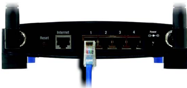
Figure 4-6 : Connexion de vos périphériques réseau
