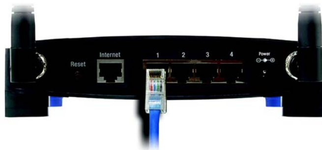
Abbildung 4-6: Anschließen der Netzwerkgeräte
