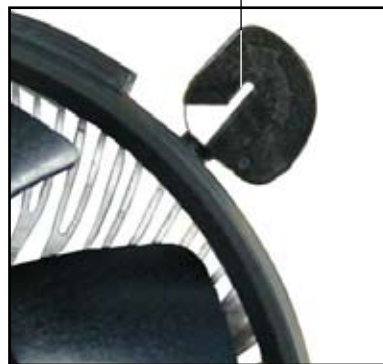
扣具末端的窄道溝槽
