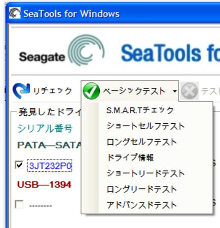
[Short Drive Self Test (ショット DST テスト)] を起動すると、大部分のドライブは、ハード ドライブのファームウェアに組み込まれた診断ルーチンを実行します。DST では、データが完全に保護されます。
