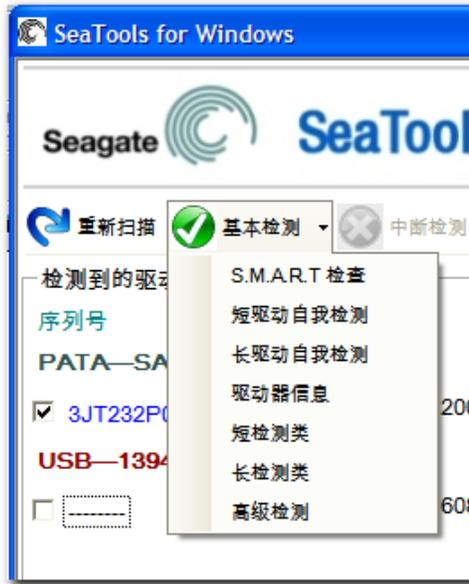
启动“短驱动自我检测”(DST)后,大多数硬盘将运行内置在硬盘固件上的全面诊断例程。DST 完全不会破坏数据。
