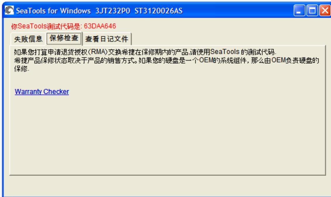
SeaTools 测试代码取决于未通过检测的类型以及产品序列号。每个代码都是唯一的。RMA 在线提交系统将通过 SeaTools 测试代码来协助您更换产品。该代码告诉 Seagate 该硬盘确实有问题。退回的硬盘绝不可能是没有问题的硬盘。
